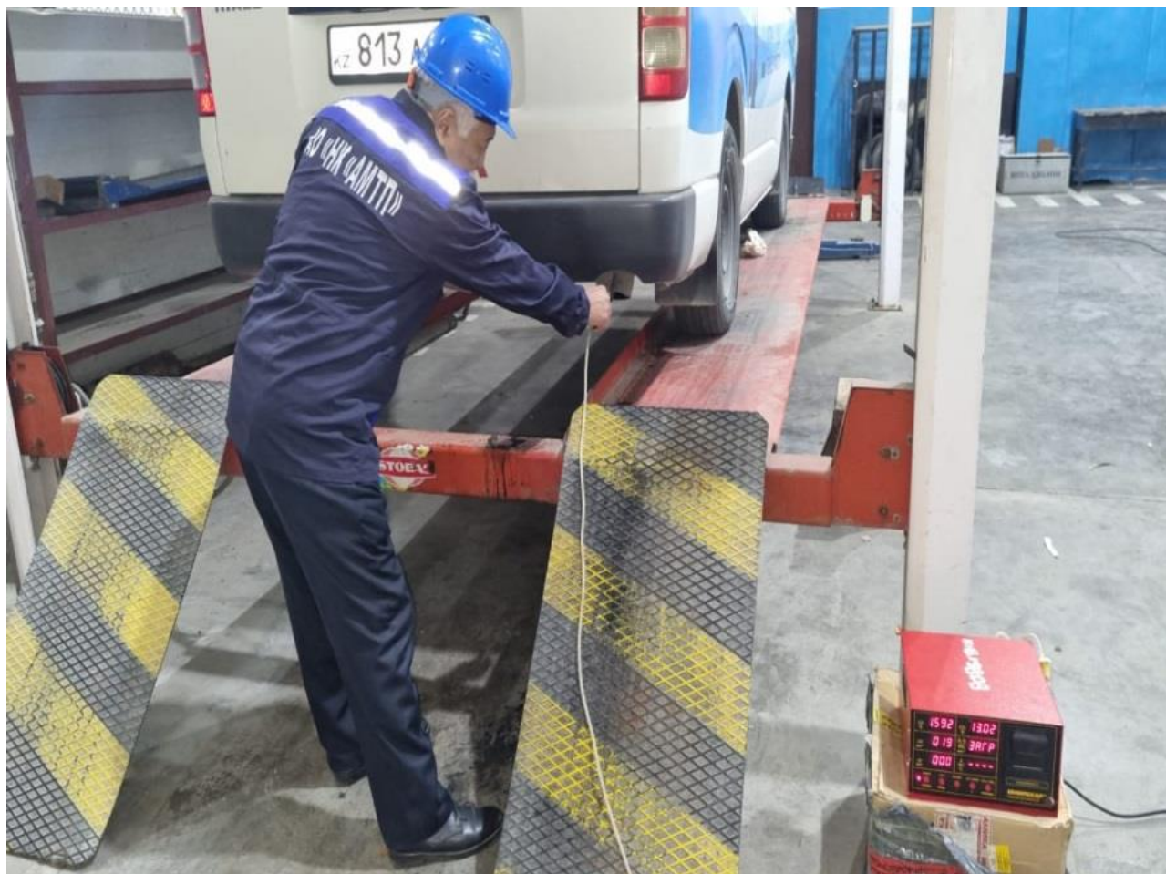
СО және СН құрамындағы пайдаланылған газдарды өлшеуді жүзеге асыру процесі газ анализаторында
