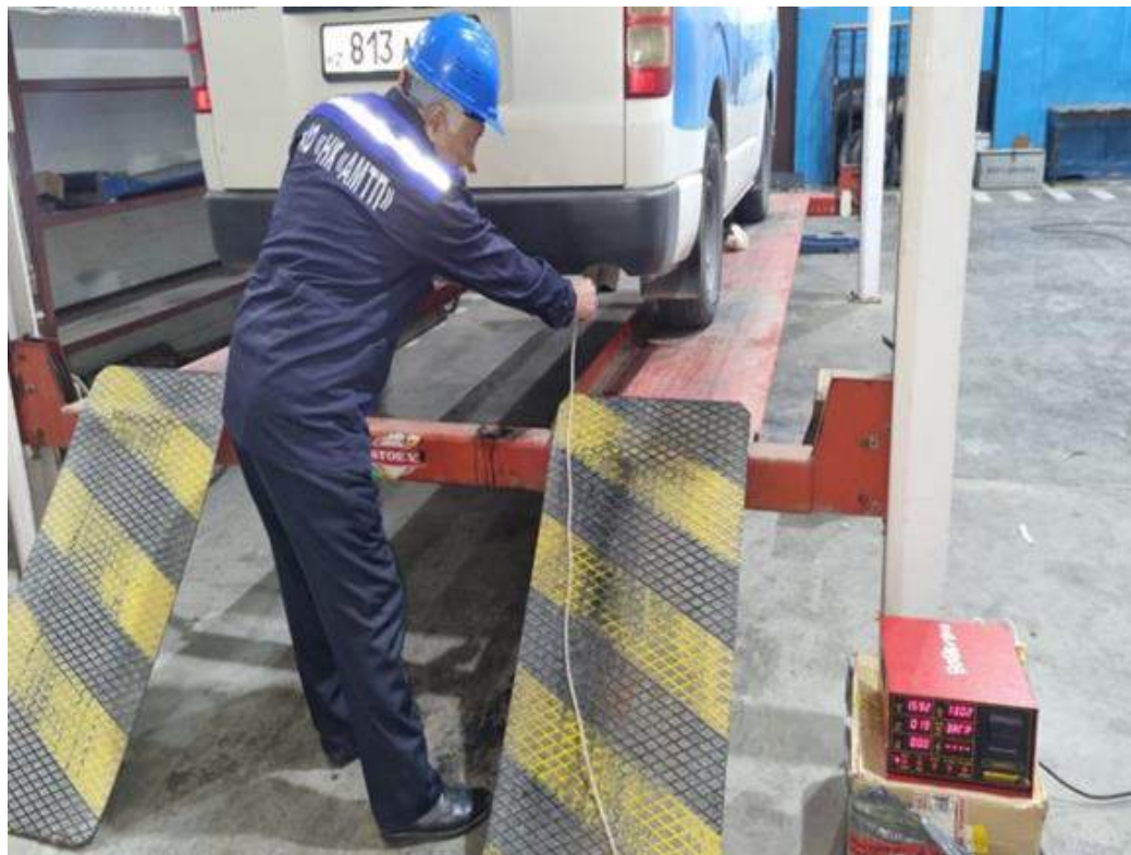
Процесс замеров выхлопных газов на содержание CO и CH на газоанализаторе
