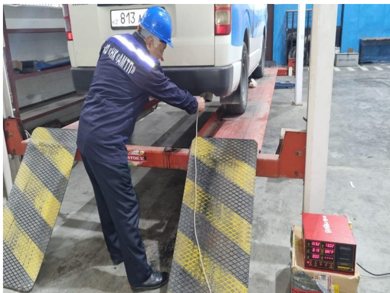
СО және СН құрамын газталдағыш арқылы өлшеу процесі (пайдаланылған газдар)
